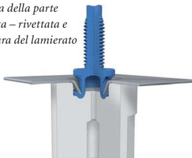
Elemento di fissaggio e lamierato uniti.
