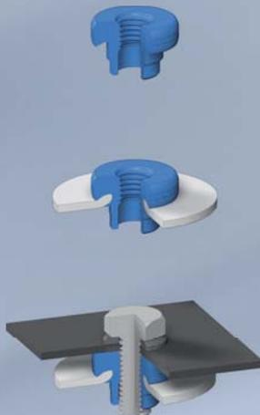
A seconda della posizione di inserimento la boccola prende la funzione di centratore o di distanziale (dis. EMF- boccola tonda con funzioni di distanziale).
