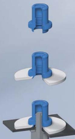
Boccola tonda autorivettante che necessita di poco spazio per carichi dinamici, statici ed Intermittenti. La chiusura protegge dalla penetrazione di materiali estranei.
