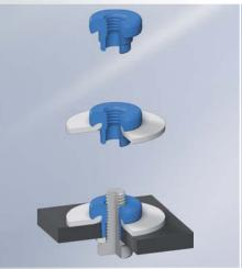
A seconda della posizione di inserimento la boccola prende la funzione di centratore o di distanziale (fig. EMF -boccola tonda autorivettante per funzioni distanziali)
